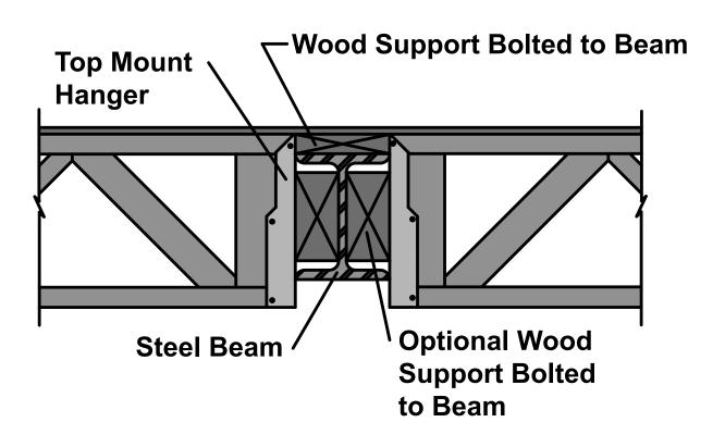
JOIST TO STEEL BEAM
